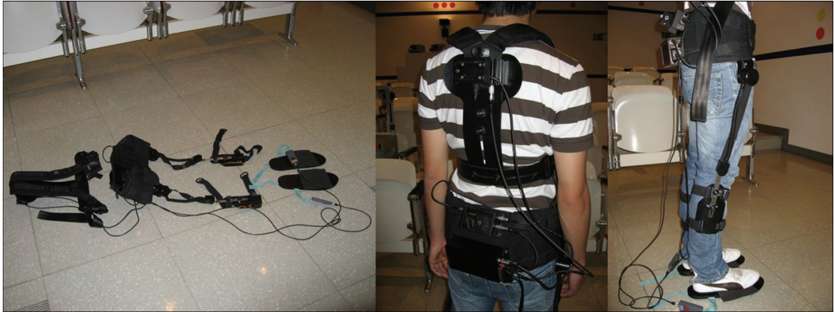
Abb. 1: Die Abbildung zeigt das Messsystem CUELA ( C omputer- U nterstützte E rfassung und L angzeit- A nalyse von Belastungen des Muskel-Skelett-Systems, BGIA (Institut für Arbeitsschutz der Deutschen Gesetzlichen Unfallversicherung, Sankt Augustin, Germany)), das zum Monitoring der Seitenbelastung während der Durchführung der arbeitsspezifischen Belastungspositionen verwendet wurde. Auf diese Weise wurde kontrolliert, ob beide untere Extremitäten gleichförmig und im Sinne des Belastungsparadigmas belastet wurden.
