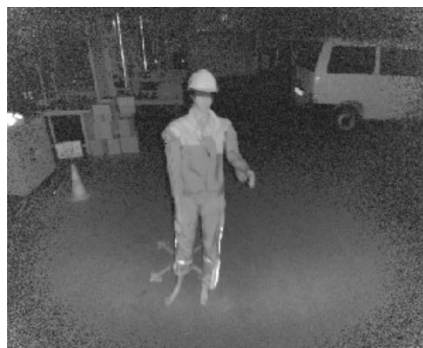
Abbildung 20: Beispiel für Kollisionsaufnahme mit Schaufensterpuppe (Microsoft Kinect v2)
