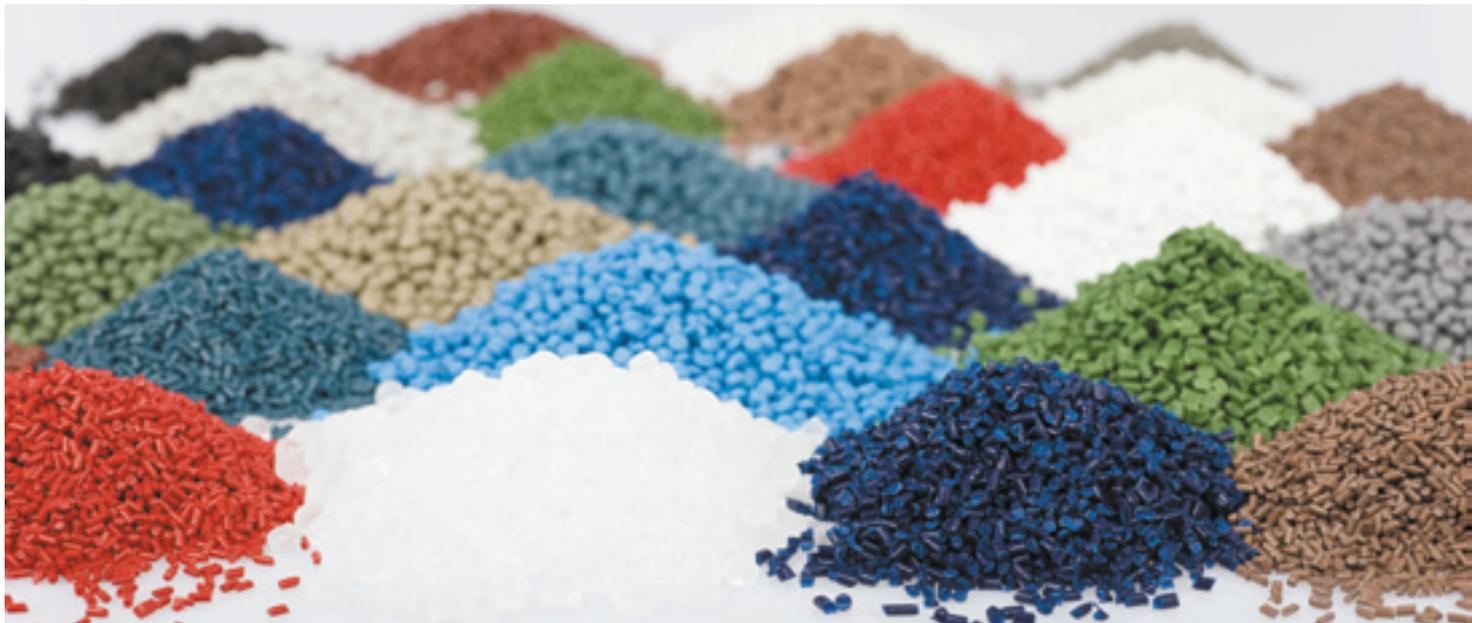
Granulate, aus denen Kunststoffprodukte hergestellt werden.
