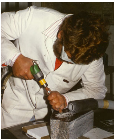
Abbildung 1: Typische Handhabung eines Schriftenmeißelhammers mit Meißel
