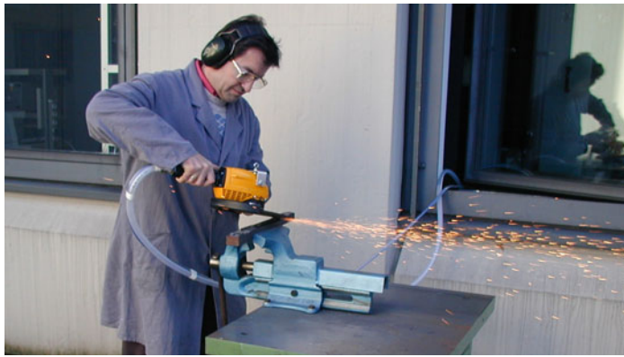
Abbildung 7: Schleifmaschine mit Antivibrationssystem
