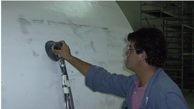
Abbildung 6: Exzentrerschleifer in der Flugzeuglackierung
