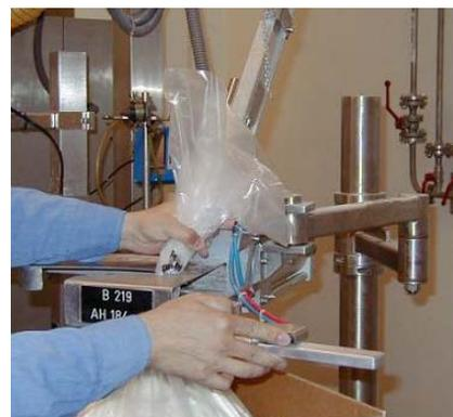
Das Einfüllen von Sackware in Fässer ist stets mit hohen Staubkonzentrationen verbunden, E-Staub-Konzentrationen von über  $20 \text{ mg/m}^3$  sind keine Seltenheit (Abbildung 11, siehe Seite 24). Eine deutlich emissionsärmere Art der Einfüllung zeigt Abbildung 12 (siehe Seite 24): Mittels eines Hubwagens wird der einzufüllende Sack
