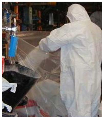
o-Phthalodinitril wird aus Wechselcontainern in einer abgesaugten Kabine eingefüllt (Abbildung 17, siehe Seite 26). Ein Rüttler beschleunigt den Einfüllvorgang. Der durch PSA geschützte Beschäftigte betritt die Kabine nur zu Kontrollzwecken und zum Wechseln des Containers (Abbildung 18, siehe Seite 26). Staubkonzentrationen wurden nur innerhalb der Kabine festgestellt.
