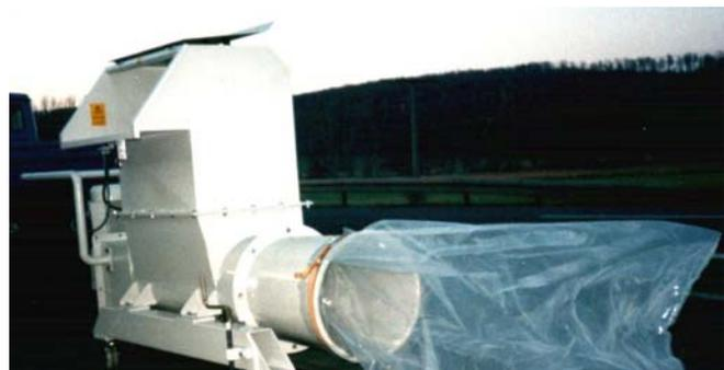
Für kontaminationsfreie Handhabung, z. B. von gesundheitsgefährdenden Produkten, ist die Schlauchfolienverpackung besonders geeignet. Über die am Außenmantel der Schnecke mittels Bajonettverschluss befestigte Aufnahmhülse (auch als Kartusche bezeichnet) werden 40 oder 50 m patentgespulte Schlauchfolie gestülpt und am Ende verschlossen. Das Bestücken kann außerhalb der Produktionsstätte erfolgen. Ist eine zweite Kartusche vorhanden, können die Rüstzeiten auf ein Minimum reduziert werden.
