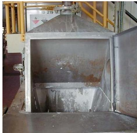
Farbsalze werden oft aus Fässern zur Weiterbearbeitung in Rührbehälter eingetragen. Diese Behälter sind mit einer Absaugung versehen, wodurch die gemessene Staubkonzentration sehr gering ist (Abbildungen 13 und 14, siehe Seite 25).
