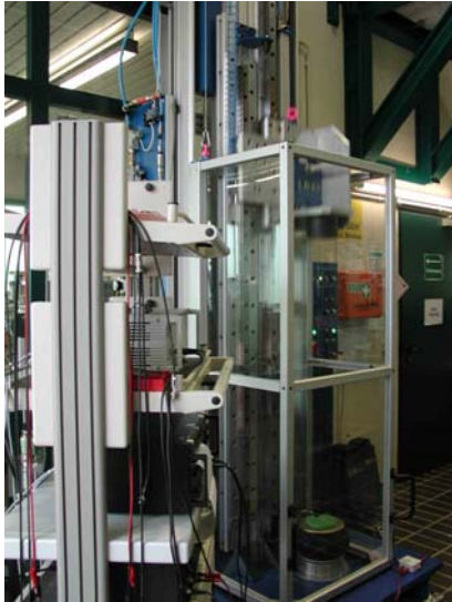
Abbildung 2-45: Prüfstand zur Ermittlung der Langzeitbelastung an Bremsen für Linearantriebe
