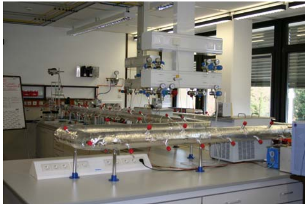
Abbildung 2-19: Prüfgasstrecke im BGIA
