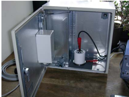
Abbildung 2-24: Versuchsapparatur zum Bestimmen der Leitfähigkeit von Staubschüttungen
