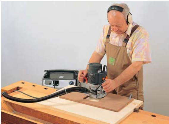
Abbildung 2-13: Arbeit mit abgesaugter Handoberfräse
