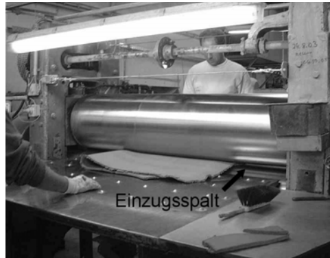
Abbildung 2-43: Kalander zur Schleifmittelherstellung mit gefährlichem Einzugsspalt
