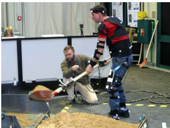
Abbildung 2-35: Messung von Handkräften und Körperhaltungen bei Schaufeltätigkeit
