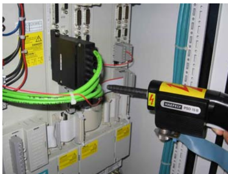
Abbildung 2-47: Prüfung durch elektrostatische Entladung
