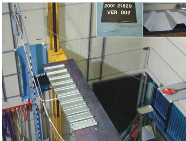
Abbildung 2-40: Versuchsaufbau für den horizontalen Einsatz von PSA
