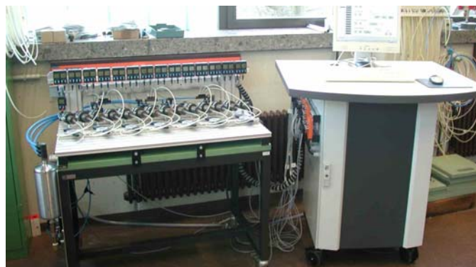
Abbildung 2-44: Prüfstand zur Ermittlung der Zuverlässigkeit an Pneumatikventilen
