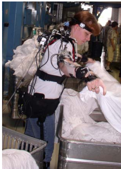
Abbildung 2-38: Ermittlung der Schulter-Arm-Belastung bei Tätigkeiten in einer Großwäscherei
