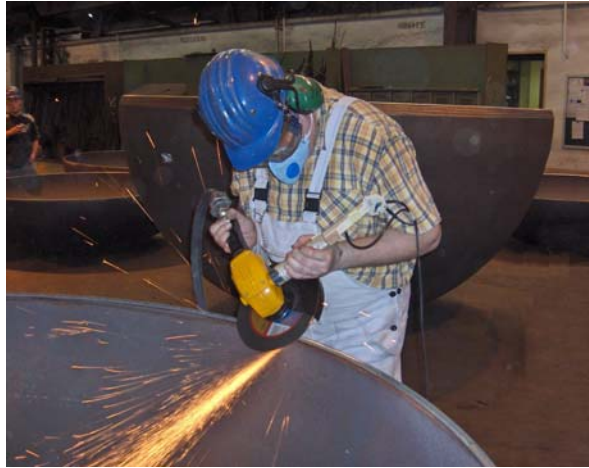
Abbildung 2-29: Messung der Hand-Arm-Vibrationsbelastung beim Schleifen
