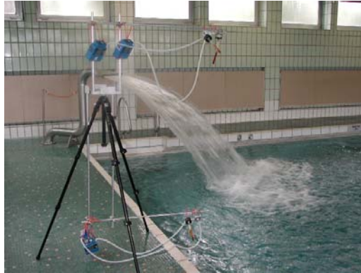
Abbildung 2-14: Probenahme an einer Wasserattraktion im Hallenband
