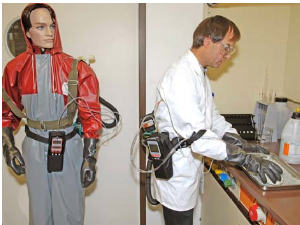
Abbildung 2-41: In-Situ-Durchbruchmessungen: Messaufbau am Modell und im Labor
