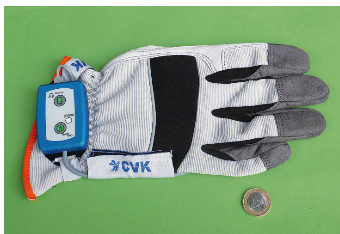
Bild 12 Dosimeter für Hand-Arm-Schwingungen (personengebunden).
