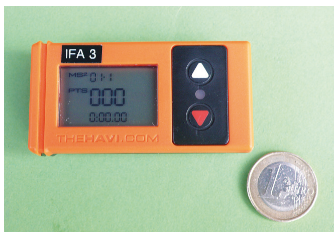
Bild 13 „Schätzhilfe“ für Hand-Arm-Schwingungen (maschinengebunden).
