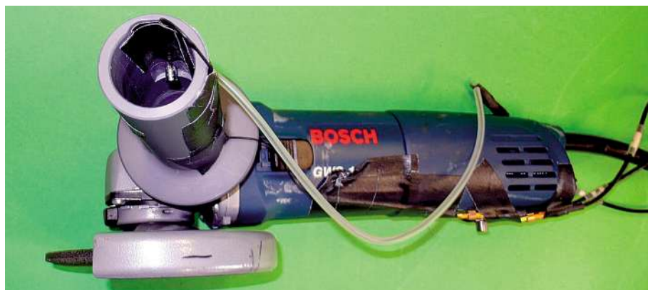
Bild 3: Messsensoren zur Erfassung der Vibrationsübertragung sind am Seitengriff eines Winkelschleifers angebracht.
