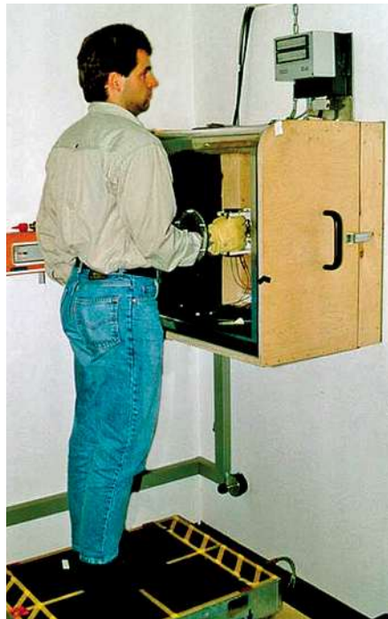
Bild 2: Prüfstand für Vibrations-Schutzhandschuhe.
