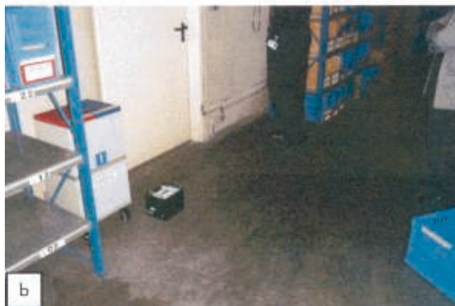
Bild 12 Vergleichende Prüfung der Rutschhemmung bei Verschleiß, a: Messung der verschlissenen Oberfläche, b: Vergleichsmessung auf der nicht verschlissenen Oberfläche vor einem Notausgang.
