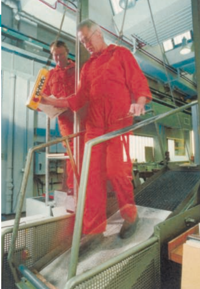
Bild 4 Prüfung der Rutschhemmung von Bodenbelägen nach dem Begehungsverfahren auf der Schiefen Ebene.
