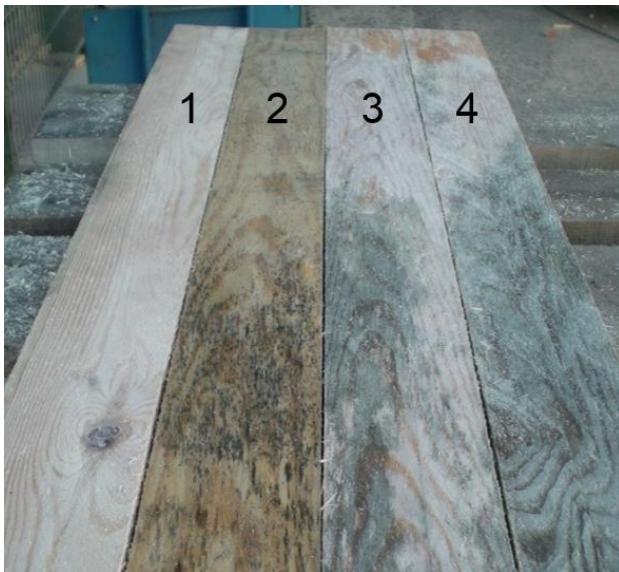
Bild 2: 1: Nicht befallenes Holz; 2: Schimmelpilzbefall, abkratzbare oberflächlicher Belag; 3, 4: Bläuepilzbefall, kein abkratzbare oberflächlicher Belag
