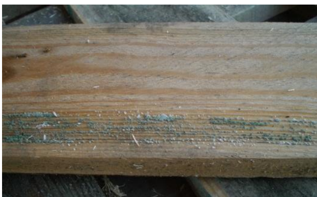
Bild 1: Schimmelpilzbefall an Hölzern für Transport- und Verpackungsmaterial
