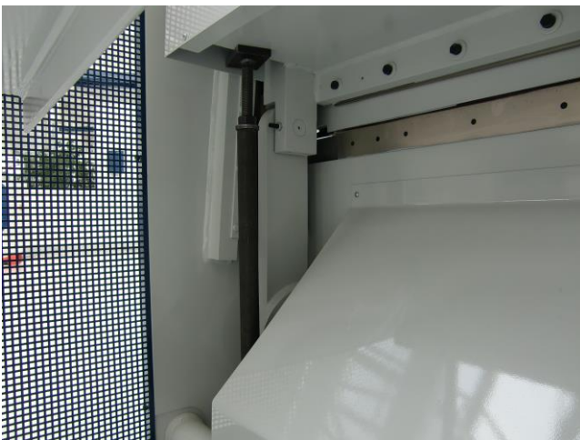
Bild 4: Hochhalteeinrichtung für Einrückung der Messerbewegung
