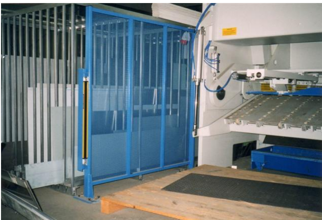
Bild 3: Lichtschranke an der Rückseite einer Tafelschere
